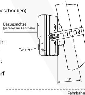
**Achtung:** Das Rotlicht darf bei Verwendung nicht durch andere Gegenstände verdeckt werden und muss senkrecht ausgerichtet sein. (Die Sattelstütze befindet sich im 11° Winkel zum senkrecht montierten Schlusslicht)
